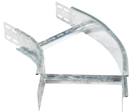
**Technical:****Product Type** Flat Bend**Width** 300mm**Height** 100mm**Weight** 2.90 Kgs**Angle** 45°**Diameter** 300mm Radius**Gauge** 1.5mm**Material** Post Hot-Dipped Galvanised (HDG)**Colour/Finish** Self Colour**Standards** BS EN ISO 1461:2009**Important:**
