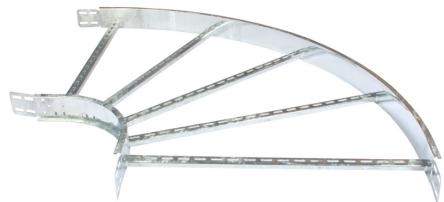
**Technical:****Product Type** Flat Bend**Width** 900mm**Height** 100mm**Weight** 11.30 Kgs**Angle** 90°**Diameter** 300mm Radius**Gauge** 1.5mm**Material** Post Hot-Dipped Galvanised (HDG)**Colour/Finish** Self Colour**Standards** BS EN ISO 1461:2009**Important:**
